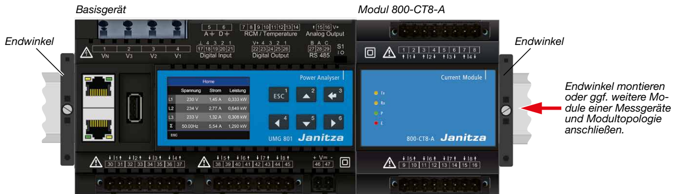
Abb. Frontansicht des Basisgeräts, hier ein UMG 801 mit Modul 800-CT8-A (Montagebeispiel - Ansicht ohne Klemmen)
