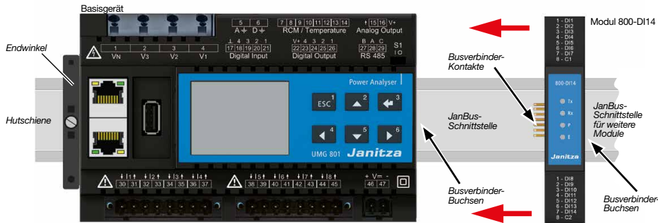
Abb. Montage-Beispiel: Frontansicht Basisgerät mit Modul 800-DI14
