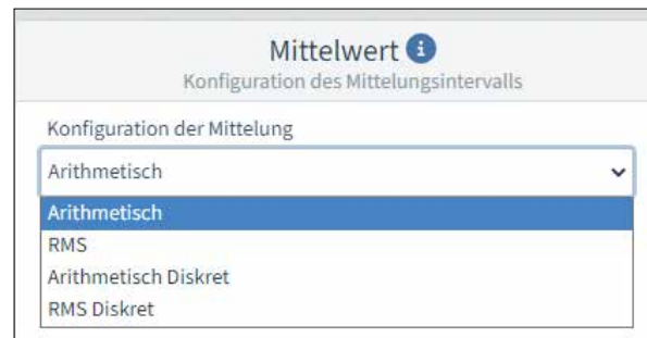
Konfiguration der Mittelung in der Software GridVis® (Art der Mittelwertbestimmung - Berechnung der Mittelwerte)
