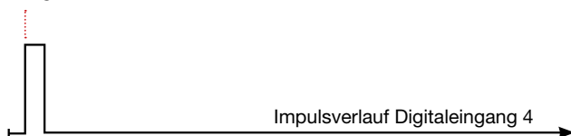
Abb.: Prinzip Impulsverlauf am Digitaleingang 4 - steigende Flanke
