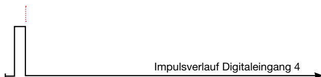
Abb.: Prinzip Impulsverlauf am Digitaleingang 4 - fallende Flanke
