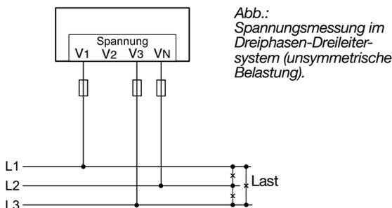
Abb.: Spannungsmessung im Dreiphasen-Dreileitersystem (unsymmetrische Belastung).
