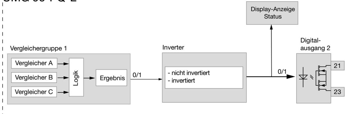
Abb. Blockschaubild "Verwendung des Digitalausgangs 2 zur Grenzwertüberwachung"
