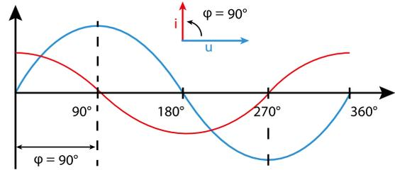
Bei einer Kombination der Zustände kann der Phasenwinkel „Strom zu Spannung“ Werte zwischen -90° und +90° annehmen.
