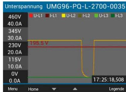
Anzeige – Sequenz einer Unterspannung im Dreiphasen 4-Leitersystem
