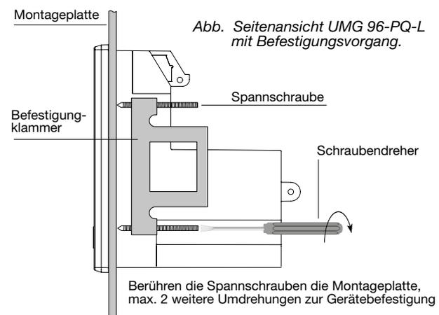
Abb. Seitenansicht UMG 96-PQ-L mit Befestigungsvorgang.
