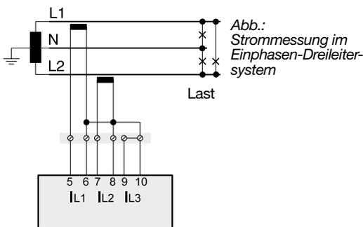
Abb.: Strommessung im Einphasen-Dreileiter-system
