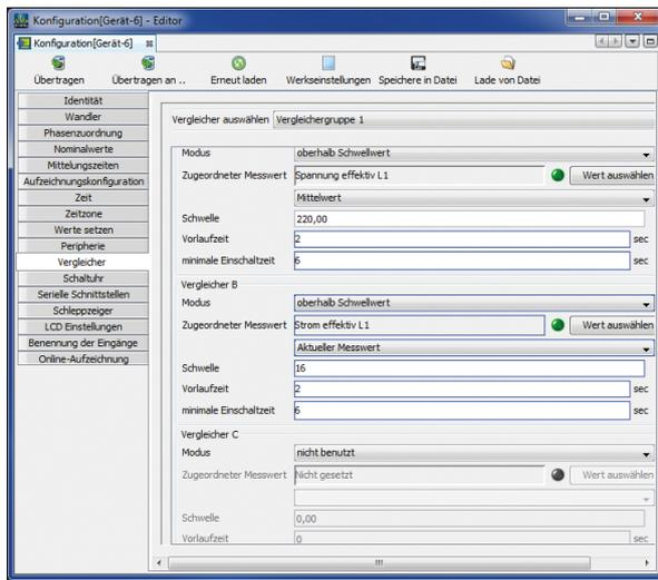
Abb. Konfiguration der Vergleich in der Software GridVis®
