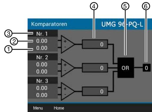
Abb. „Komparatoren“ im Menü „Peripherie / Komparatoren“
