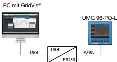
1. Verwendung des UMG 96-PQ-L (Server-Gerät) über ein UMG mit Gateway-Funktionalität (z.B. UMG 512 - Client-Gerät):
