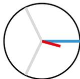
Spannung und Strom haben nur eine geringe Abweichung in der Phasenlage.
