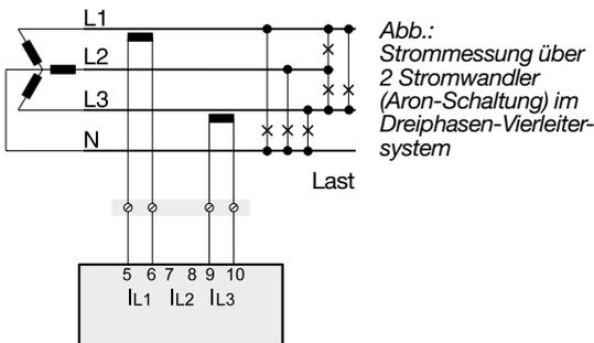
Abb.: Strommessung über 2 Stromwandler (Aron-Schaltung) im Dreiphasen-Vierleiter-system
