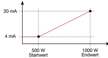
Bei der Wirkleistung 500 W beträgt der Strom am Analogausgang 4 mA, bei einer Wirkleistung von 1000 W --> 20 mA.
