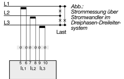
Abb.: Strommessung über Stromwandler im Dreiphasen-Dreileiter-system
