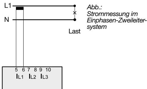
Abb.: Strommessung im Einphasen-Zweileiter-system
