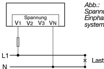
Abb.: Spannungsmessung im Einphasen-Zweileitersystem.
