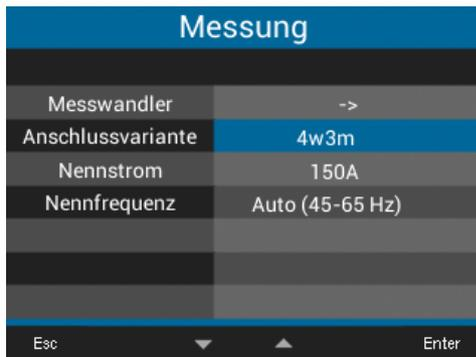
Abb. Fenster *Messung* mit markiertem Eintrag *Anschlussvariante*
