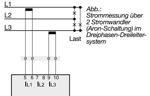
Abb.: Strommessung über 2 Stromwandler (Aron-Schaltung) im Dreiphasen-Dreileiter-system
