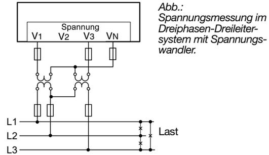
Abb.: Spannungsmessung im Dreiphasen-Dreileitersystem mit Spannungswandler.
