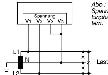
Abb.: Spannungsmessung im Einphasen-Dreileitersystem.
