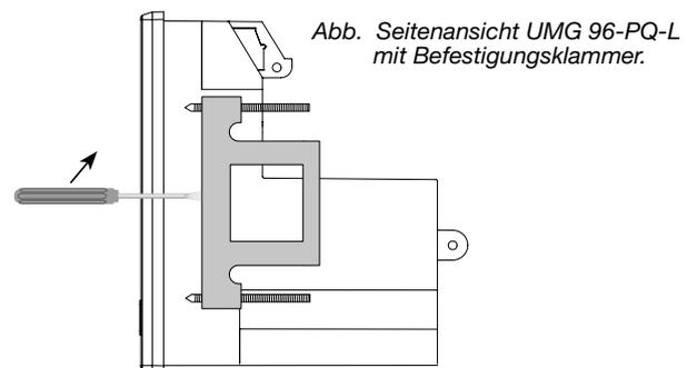
Abb. Seitenansicht UMG 96-PQ-L mit Befestigungsklammer.
