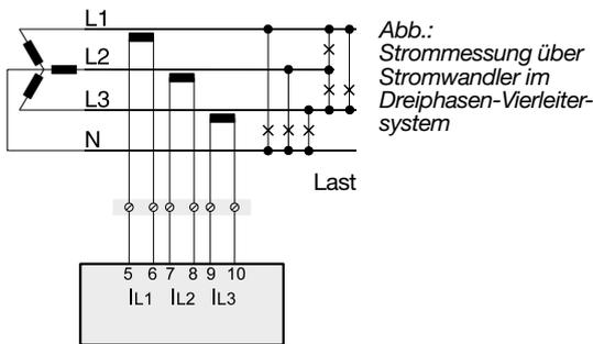
Abb.: Strommessung über Stromwandler im Dreiphasen-Vierleiter-system
