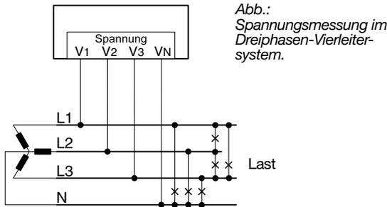
Abb.: Spannungsmessung im Dreiphasen-Vierleitersystem.
